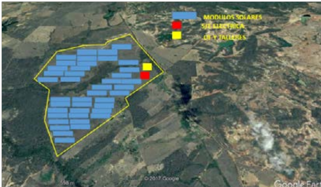
GRÁFICO 9. ARQUITECTURA DE LA PLANTA SOLAR
