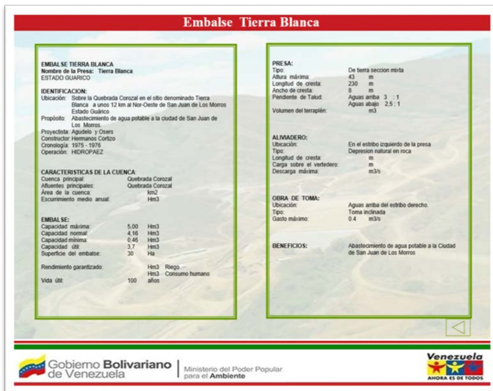
Figura 4.27. Características del Embalse y la Presa Tierra Blanca
