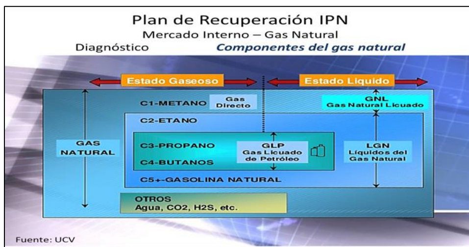
Figura N° 7.2.4.2 Componentes del gas natural
