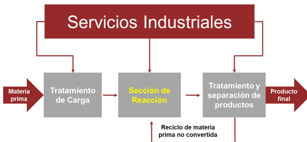
Figura N° 7.2.3.3 Esquema general de una planta petroquímica
