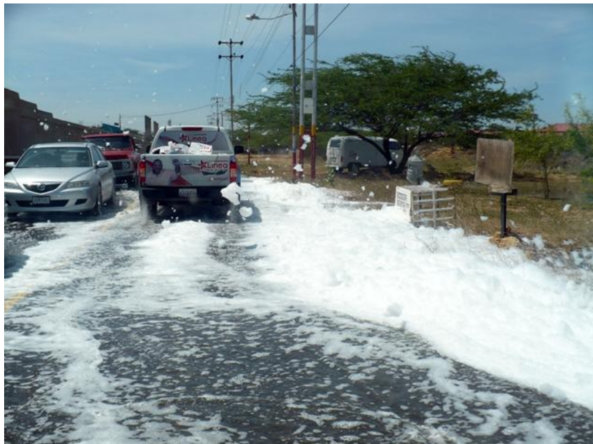
Foto 4.20: Las tuberías de aguas servidas colapsaron con la utilización de la espuma contra incendio, presentándose un brote de las mismas en los sectores residenciales de La Pastora y Creolandia
