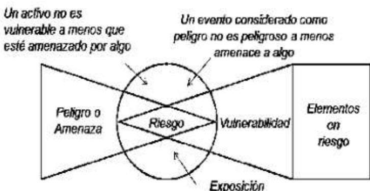
Figura 1. Relación conceptual entre la amenaza, los elementos en riesgo, la vulnerabilidad y el riesgo Adaptado de Alexander (2002); en Glade et al. (2005).
