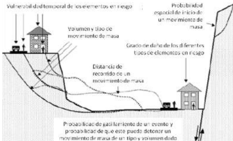
Figura 3. Representación esquemática de dos edificios (elementos en riesgo) que presentan vulnerabilidades diferentes, ya que están geológicamente situados en posiciones diversas y pueden ser afectados por diferentes tipos de movimientos de masa y de maneras diferentes (subvalorización de impacto). Tomado de Van Westen (2015).
