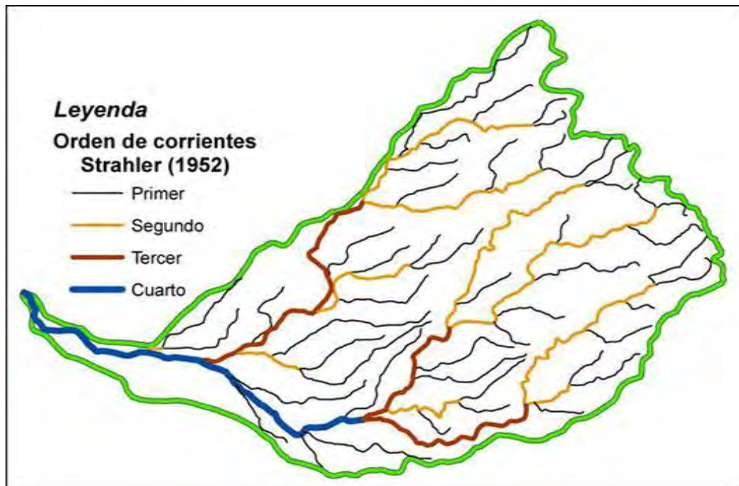
Figura N° 3. Red de drenaje de una cuenca idealizada con varios niveles de flujos superficiales.
