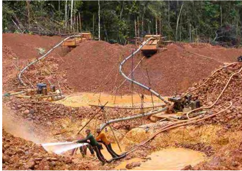
Figura N° 10. Impactos sobre los suelos por acción de monitores hidráulicos en la cuenca del río Caroní.
